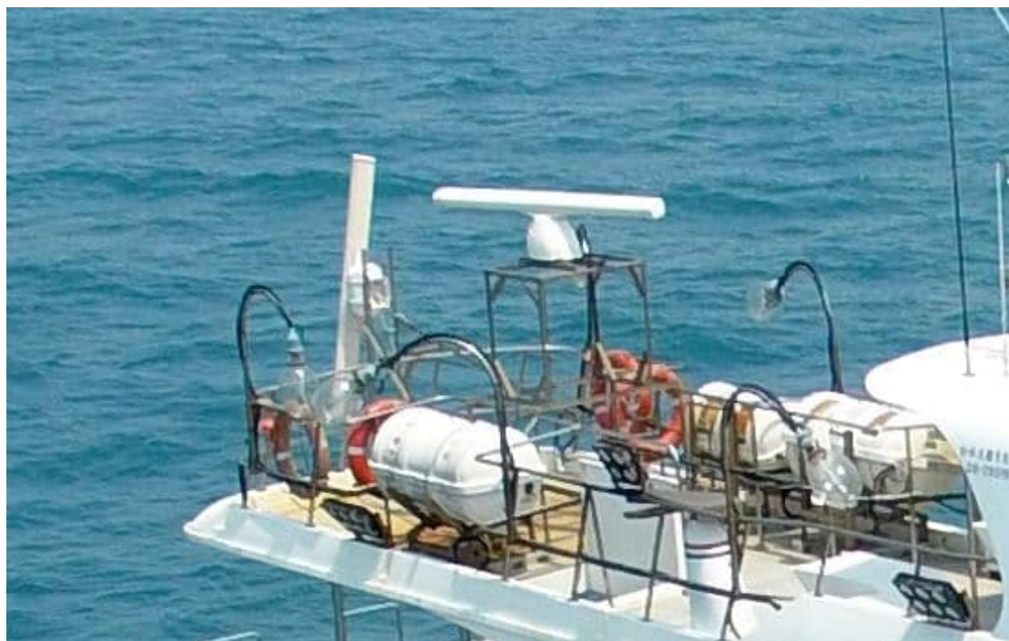
圖 2、架設於船舶上之雷達天線
