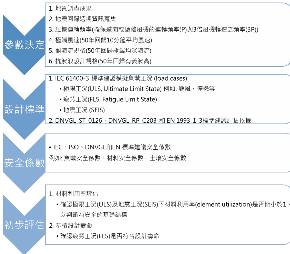
圖 4.2.2-3 風機基樁設計流程
