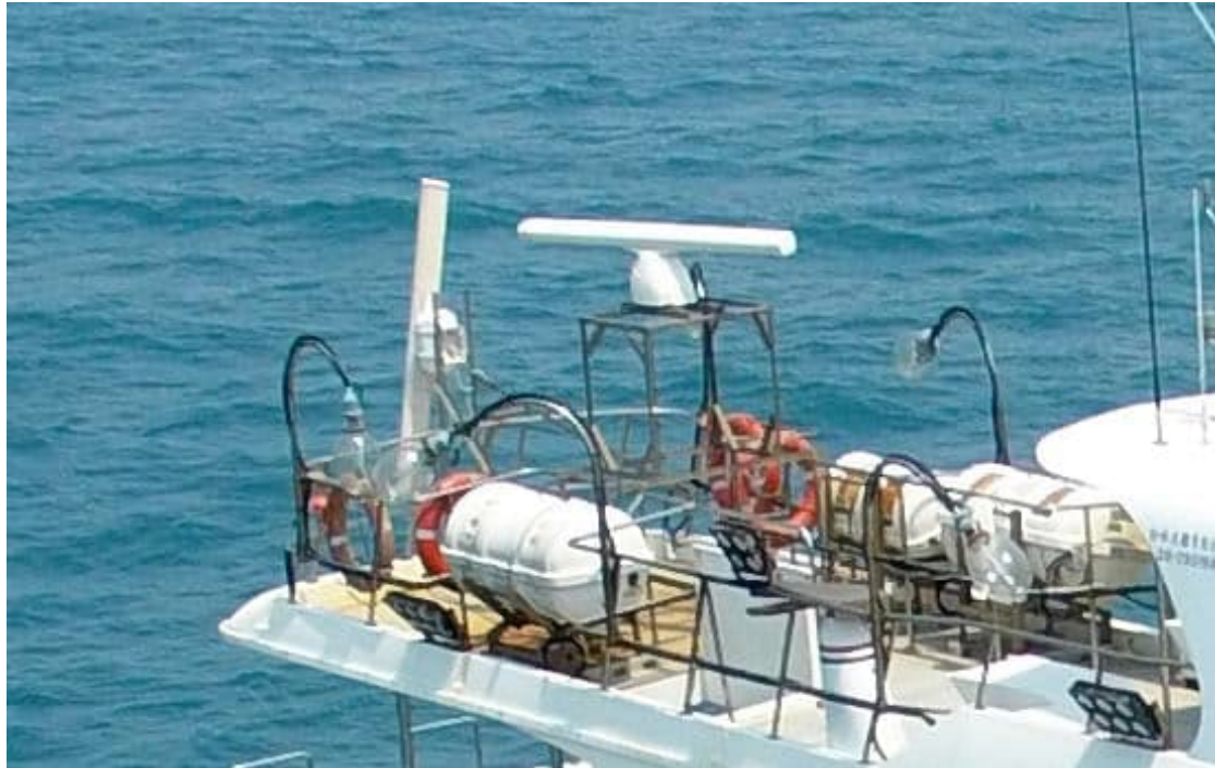
圖 2、架設於船舶上之雷達天線
